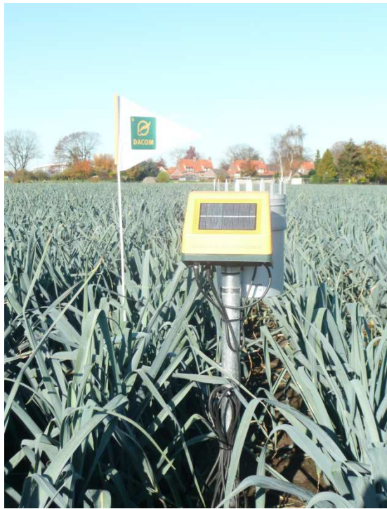
Figuur 1: vochtsensor in preiperceel bij P.H. van Dam
